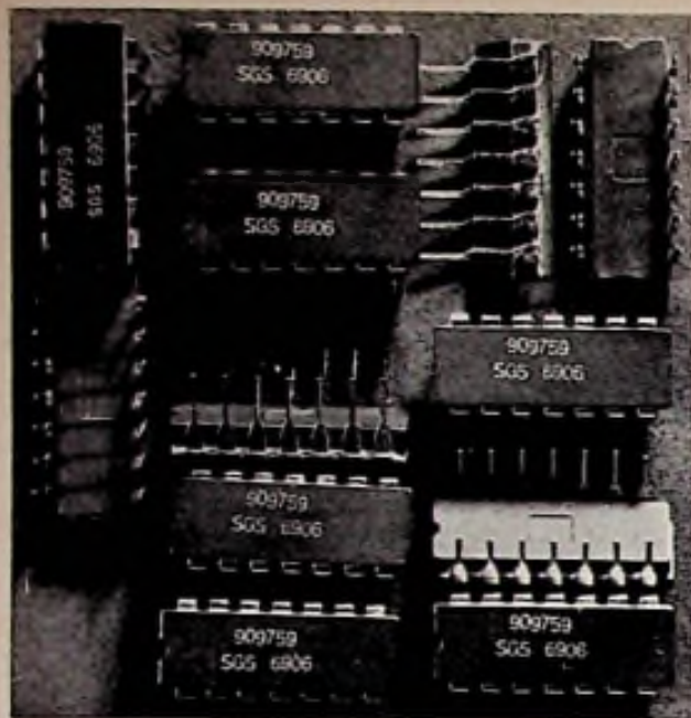
Afb. 2. DIP's of DIL's in normale uitvoering. Goed zichtbaar zijn op de foto de twee rijen pennen. In MSI en LSI gebruikt men wel DIL's met meer aansluitingen.
